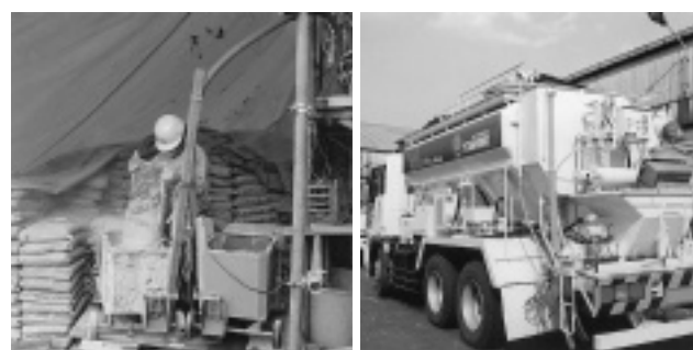
「グラウトミキサー」 「SL ローリー車」 混練装置は「グラウトミキサー」と「SL ローリー車」の2種類あります。
