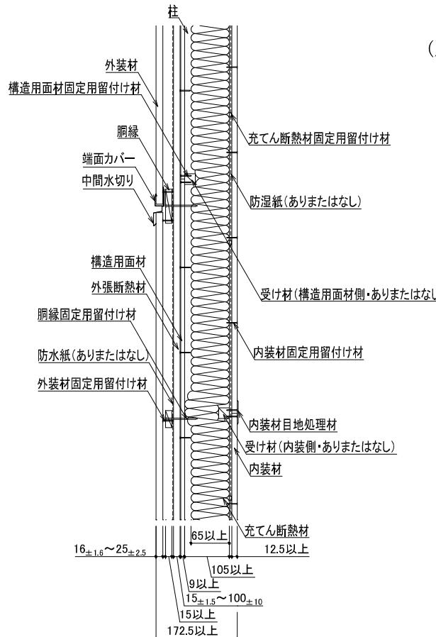
鉛直断面図 (横目地部詳細図)
