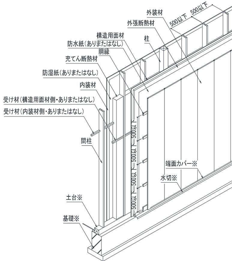
水平断面図(外装材：縦張の場合)
